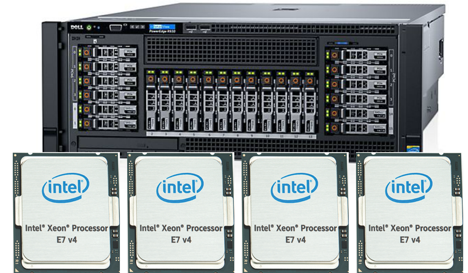
4x Intel Xeon E7: 72 cores
